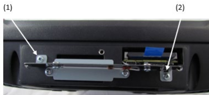
Abbildung 15-3: WLAN Diversity Antenne
