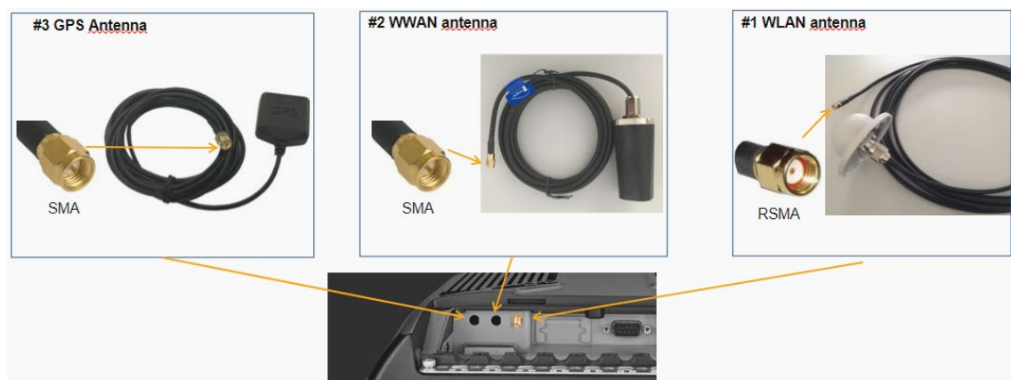
Abbildung 7-4: Anschlußbelegung externe Antennen
