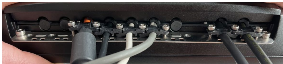
Abbildung 14-14: Kabelabdeckung geschlossen und verschraubt
